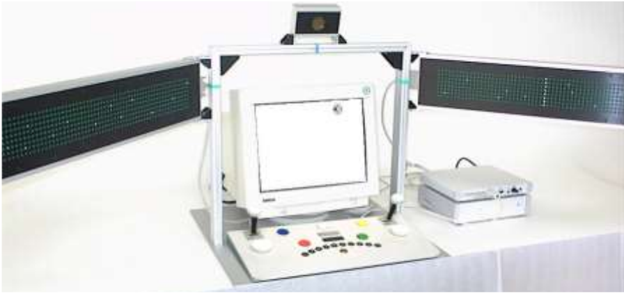
الشكل (٤): الإعداد والوضع الصحيح لجهاز إدراك المحيط.
